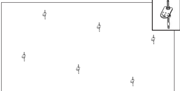
13. Brickorna till understa railen ska alltid vändas nedåt.
